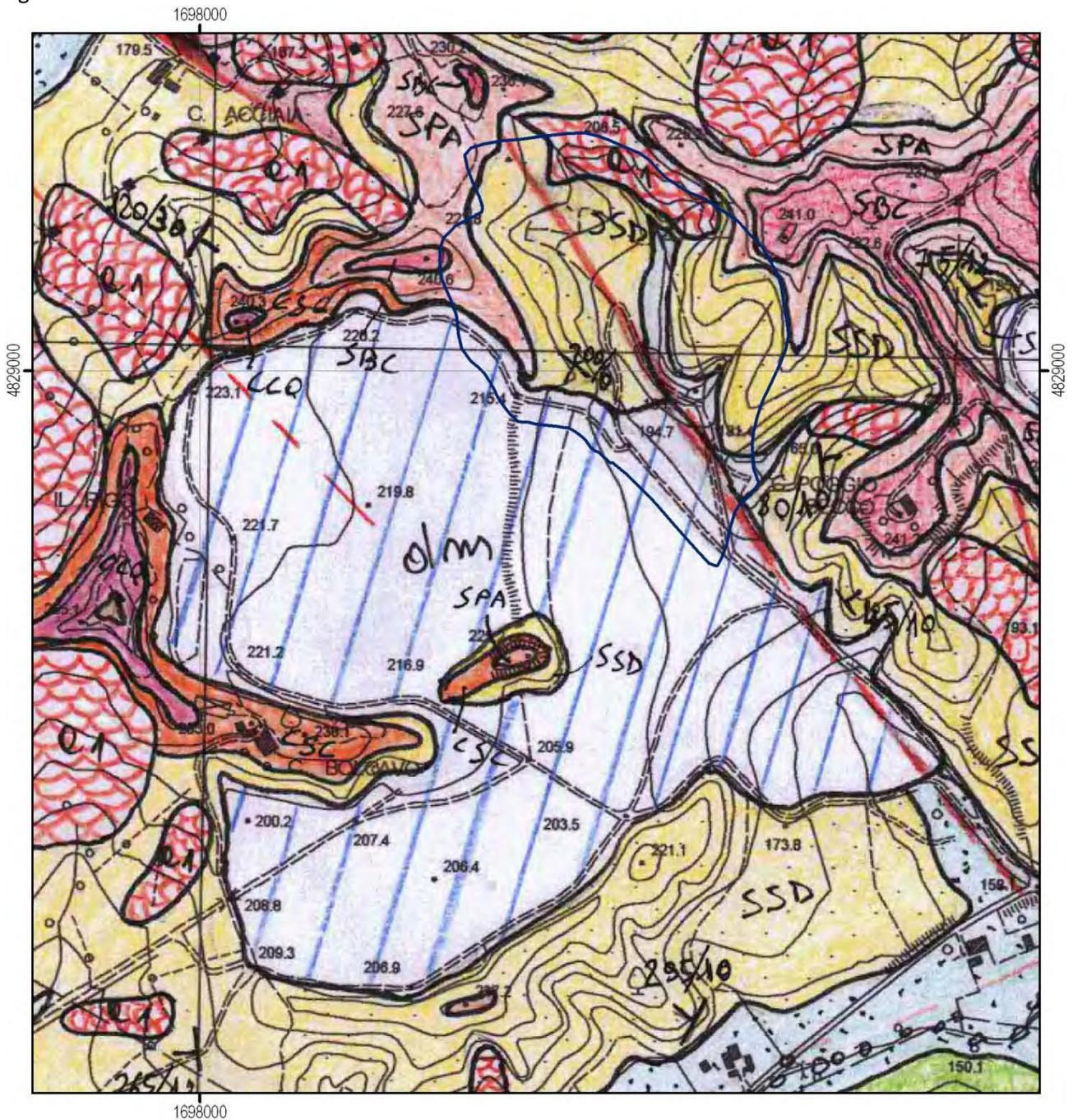
Figura 4 - Stralcio di Carta Geologica della Regione Toscana a scala 1:10.000 (qui riportata non in scala). L'area della discarica in progetto è riportata in questo caso con il colore blu per distinguerla da altri elementi geologici e geomorfologici disegnati in rosso. Si evidenzia la presenza del versante in frana e di una faglia che attraversa l'area.
