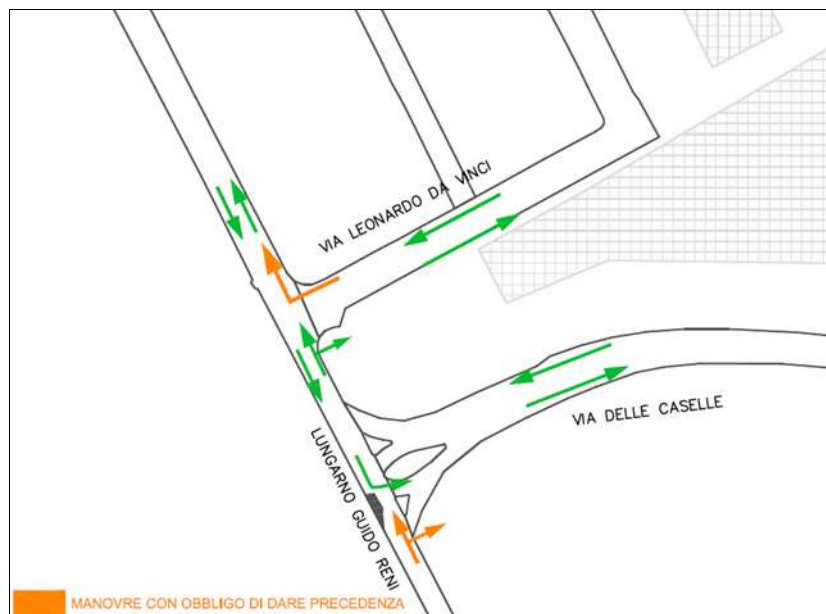
Figura 13 – Interventi localizzati della disciplina di circolazione Via delle Caselle – Lungarno Guido Reni
