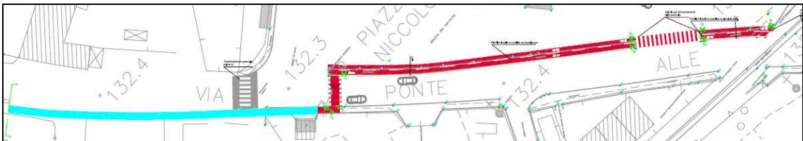
Figura 63 – Raccordo fra la pista esistente e posta di progetto su Via del Ponte alle Forche all'altezza di Piazza Niccolò Nasoni
