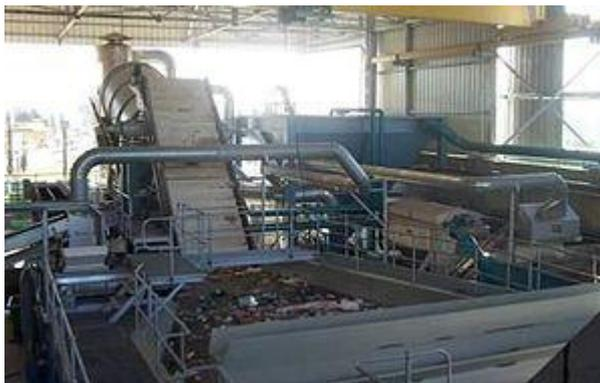
**Figura 4: Impianto per il recupero di materiali a umido.**
