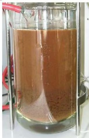
Bioreattore per l'idrolisi e fermentazione paglia di grano esplosa con sistema elicoidale di agitazione
